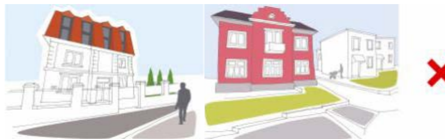
Kerüljük az épület korától, jellegétől idegen tetőfelépítményeket és divatosnak hitt díszítéseket!!
